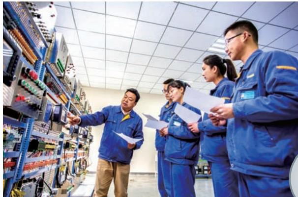
掘机、压路机、混凝土泵车四种主机产品电气控制系统实训装置为核心的工程机械电气控制系统安装与调试实训工作站,通过控制器、显示器、传感器以及各主机厂配套电气元件和执行作业终端的模拟装置和提供的模拟环境,为学院实训教学、企业职工培训、技能竞赛设备支持等方面均发挥了积极作用。
